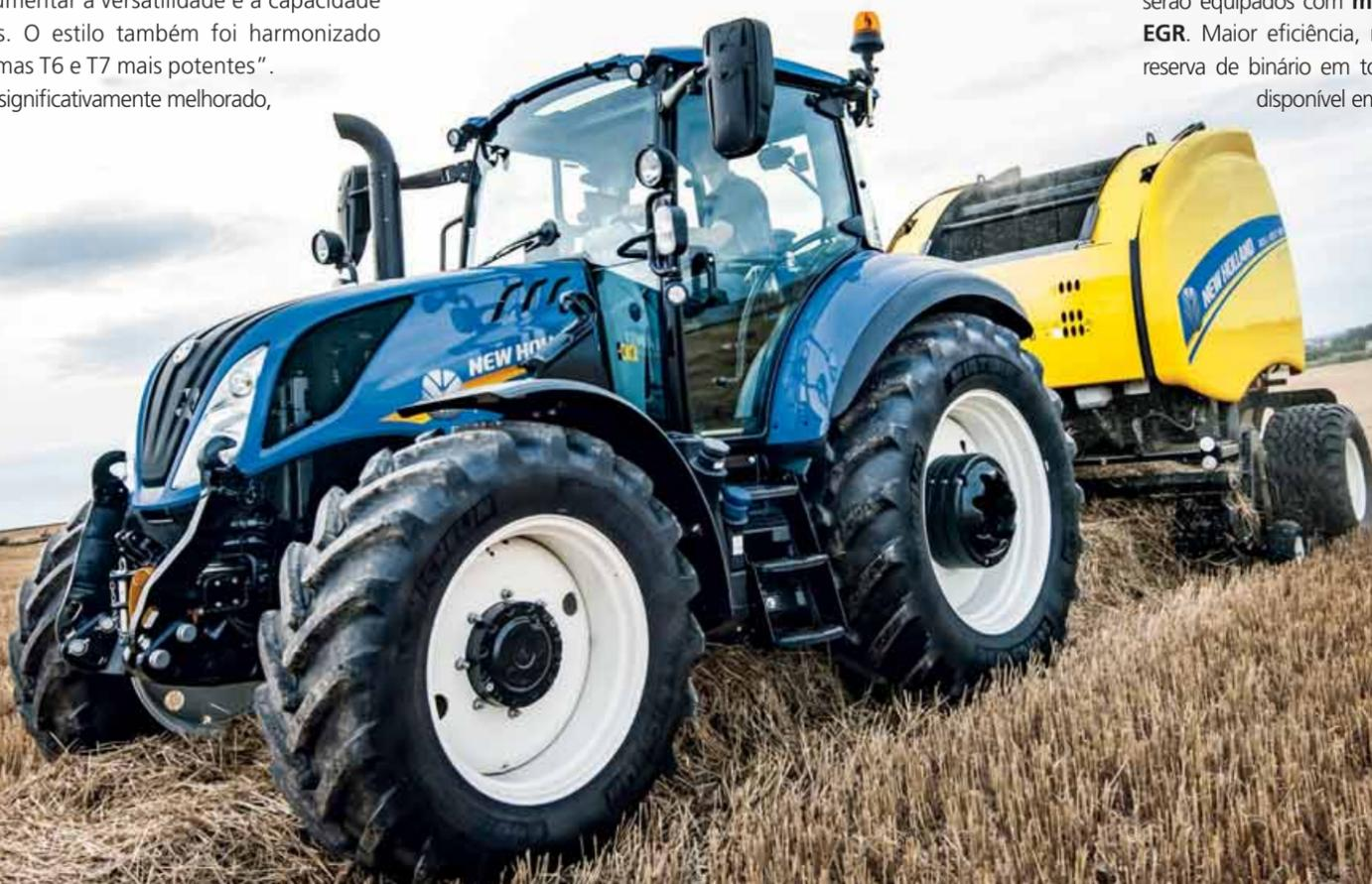
o T5.110 com 107 hp e o T5.120 com 117 hp, com um binário máximo a 1.500 rpm de 430, 468 e 491 Nm, respetivamente. Todos os modelos estão equipados com o motor F5C Common Rail de 3,4 litros com tecnologia ECOBlue™ Compact HI-eSCR e Low Rate EGR, desenvolvido e fabricado pela FPT Industrial. Os melhoramentos efetuados ao chassis permitiram aumentar o peso bruto de 7,4 para 8 toneladas e o novo eixo dianteiro fixo heavy-duty opcional permite utilizar pneus dianteiros de 28".
